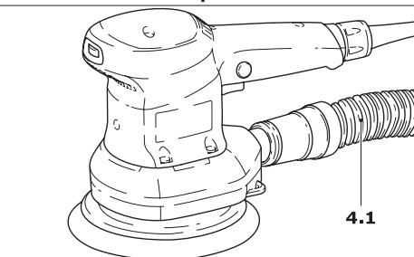
A fin de evitar un frecuente cambio del turbofiltro durante trabajos de lijado relativamente largos, en lugar del dispositivo autoaspirador se puede conectar un aspirador Festool.
